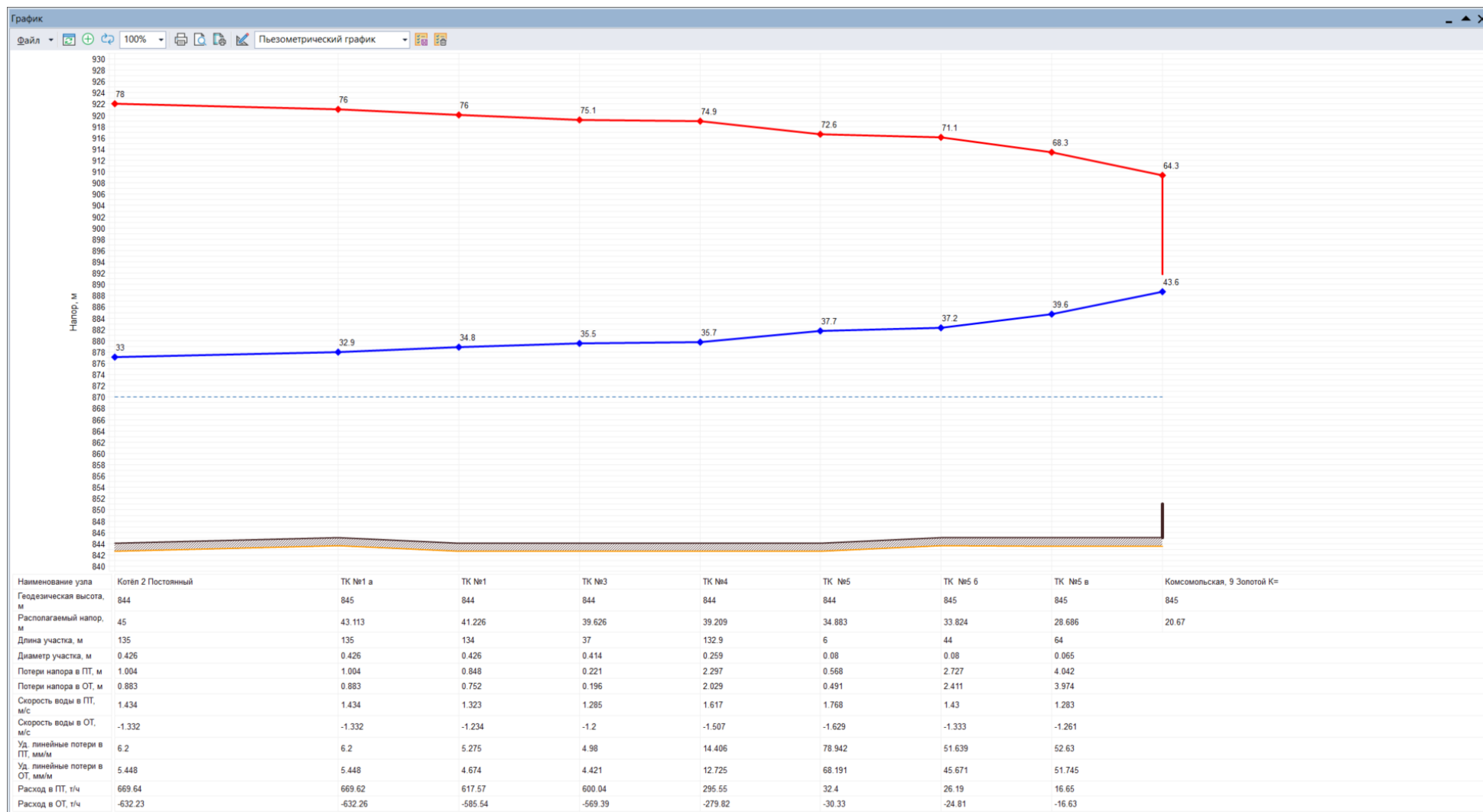
Рисунок 4.2.4. - Пьезометрический график от котельной ГУП РТ «УК ТЭК 4» участок Ак-Довуракский до потребителя – Комсомольская, 9 д/с Золотой ключик
