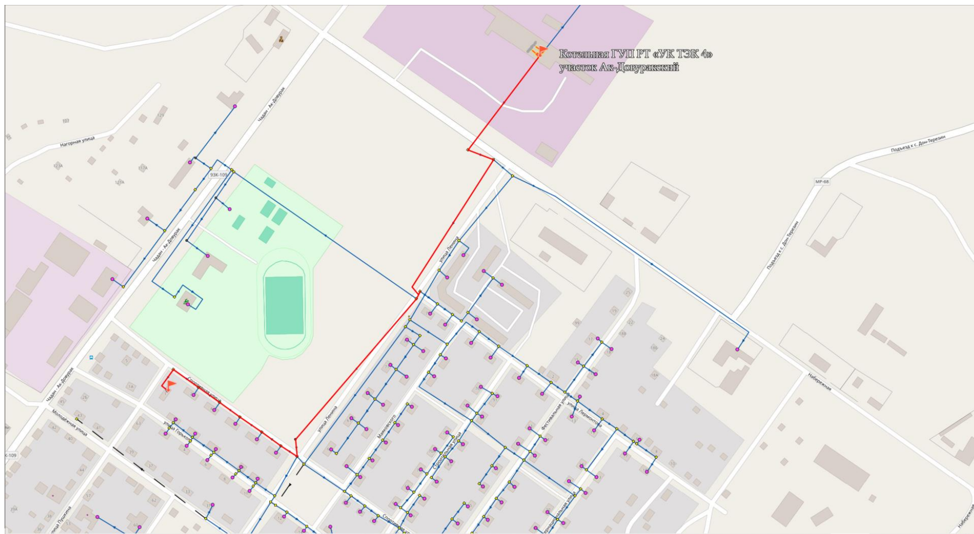
Рисунок 4.2.1. Путь для построения пьезометрического графика от котельной ГУП РТ «УК ТЭК 4» участок Ак-Довуракский до потребителя – Спортивная, 1
